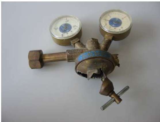
Bilder 3 und 4 ausgebrannte Druckminderer
